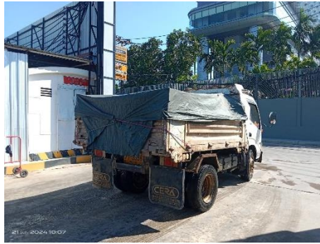
รูปที่ 9 การใช้ผ้าใบปิดคลุมรถบรรทุก
